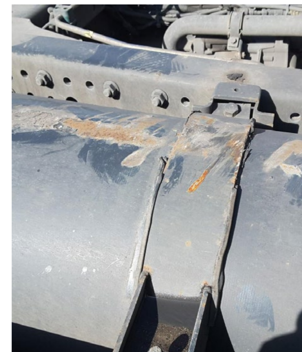
Rez, deformace, praskliny anebo díry → účtuje se výměna držáků a pásků.
