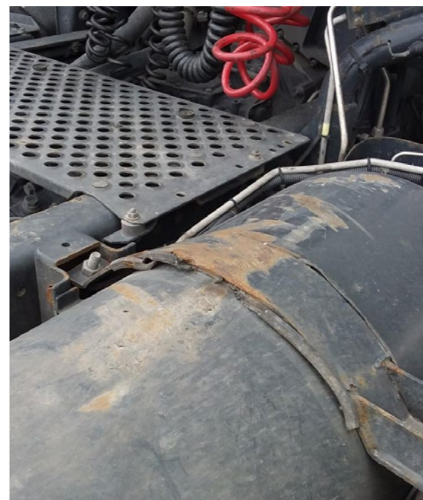
Rez, deformace, praskliny anebo díry → účtuje se výměna držáků a pásků.
