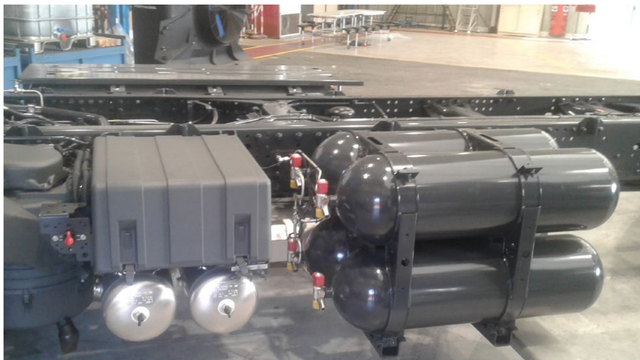
Zkontrolujte přítomnost držáků a také, zda jsou správně utažené.
