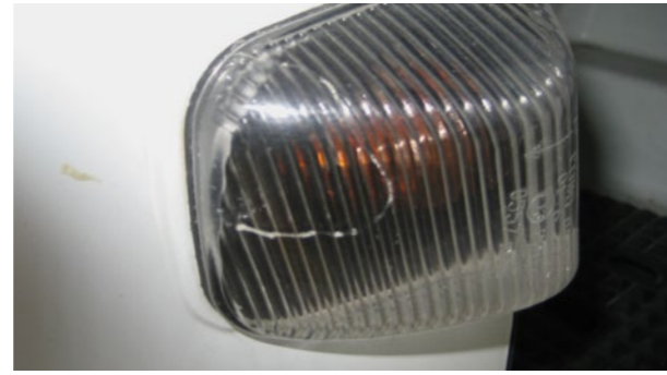
🔄 Poškodené predné a zadné svetlá
