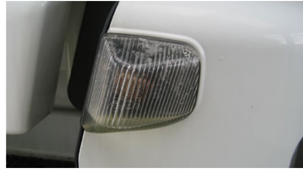
🔄 Škrabance v svetelnom poli, praskliny, kondenzácia, zlomené alebo rozbité uchytenie
