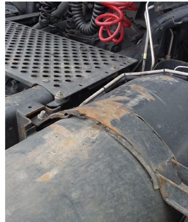
Korózia, preliačiny, praskliny a/alebo ryhy → účtuje sa poplatok za výmenu držiakov a pásov.
