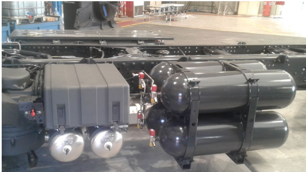
Skontrolujte, či sú držiaky a pásy prítomné a či sú správne utiahnuté.
