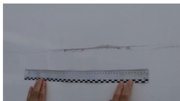
Bočné panely: škrabance s odstráneným materiálom \geq 20 cm v rámci ekonomickej opravy. Možnosť lakovania polovice panela
