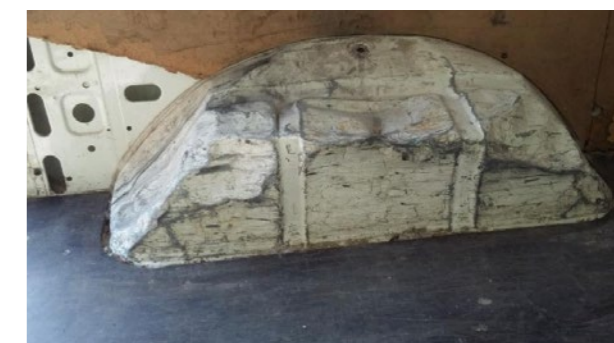
Vnútorne deformácie: perforácie, preliačiny, deformácie, ktoré nie sú súčasťou ekonomickej opravy. Denaturovaný a neopraviteľný povlak (prášok, lak atď.) (podbeh kola sa nedá opraviť, ak je čas opravy < 3 h)
