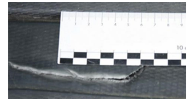
Perforácia tvrdého plastového obloženia. Paušálne hodinová sadzba na opravu tvrdého plastového obloženia, ak je esteticky prijateľné a opraviteľné
