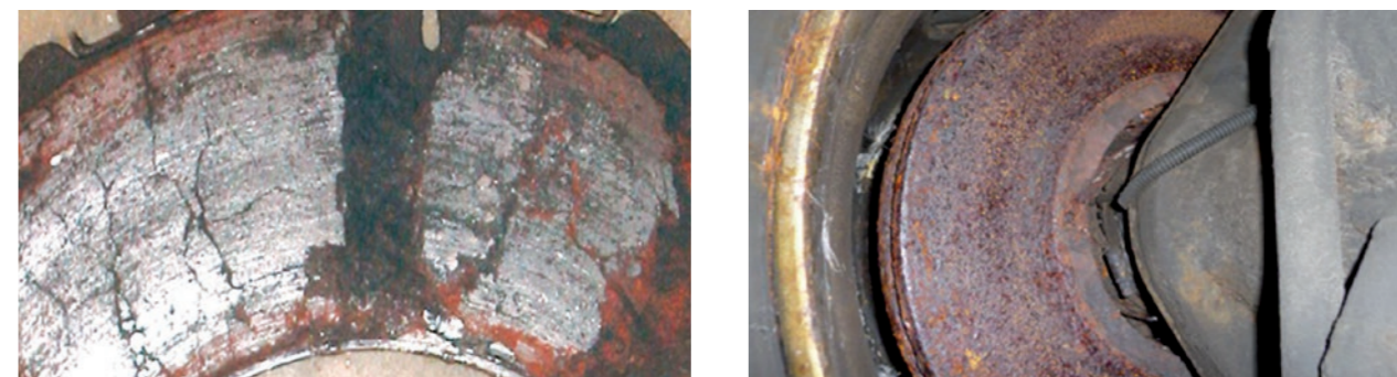
Hrdzavé, obrúsené, opotrebované brzdové kotúče
