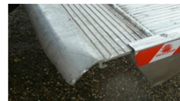
Zadná nakladacia plošina: deformácie plošiny v rámci ekonomickej opravy
