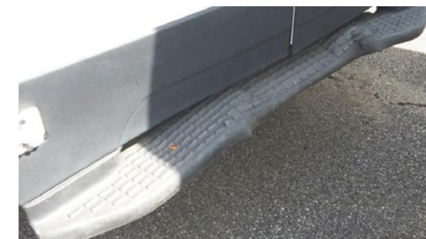
Zadný schodík: deformácie, ktoré nie sú súčasťou ekonomickej opravy
