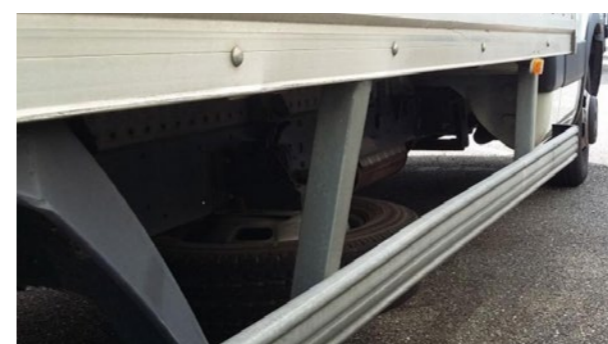
Bočná ochrana: deformácia v rámci ekonomickej opravy
