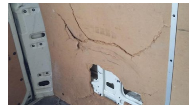
Vnútorne drevené ochranné obloženie: stopy po náraze, rozbitý panel, chýbajúci panel (okrem horných panelov dverí)
