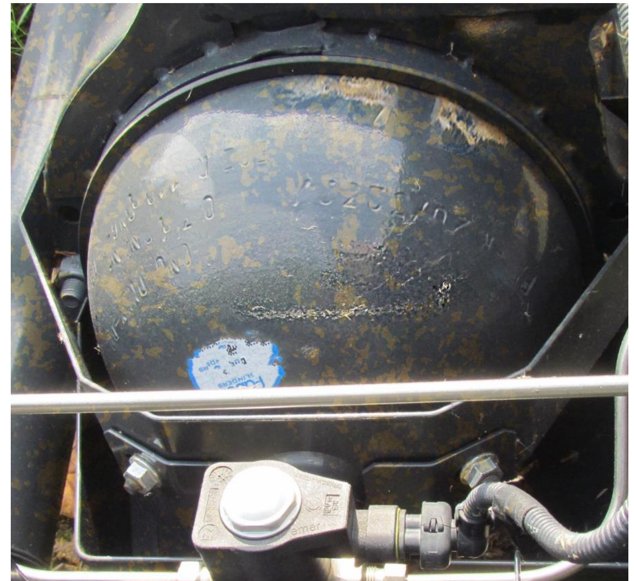
Originální identifikační značení tlakové láhve CNG chybí nebo je nečitelné – účtuje se výměna tlakové láhve CNG za novou.
