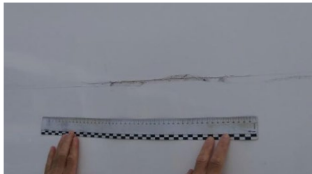
Boční panely: škrábanec s odstraněním materiálu \geq 20 cm v rámci ekonomičnosti opravy. Možnost nalakování poloviny panelu
