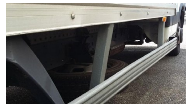
Boční ochrana: deformace rámci ekonomičnosti opravy
