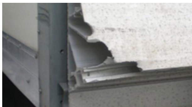
↻ Zadní nakládací plošina: deformace plošiny nad rámec ekonomičnosti opravy, rozbitý nebo neúplný profil
