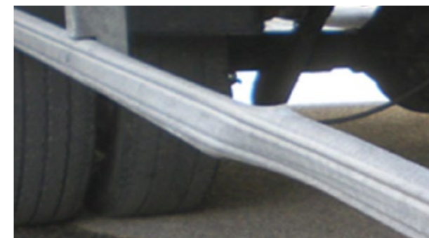
Boční ochrana: deformace nad rámec ekonomičnosti opravy
