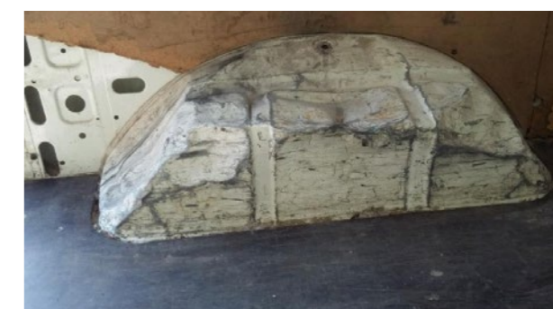
Vnitřní deformace: perforace, promáčkliny, deformace nad rámec ekonomičnosti opravy. Změna přirozených vlastností a nános, který nelze odstranit (prášek, barva atd.) (Podběh kola nelze opravit, je-li doba opravy > 3 h)
